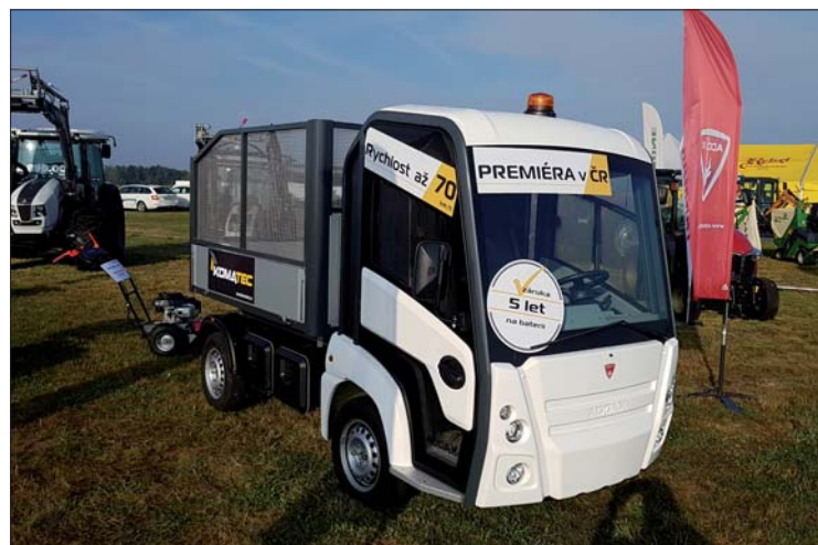
Užitková vozidla Addax s elektrickým pohonem mají dojezdovou kapacitu až 110 kilometrů a jejich přepravní rychlost dosahuje 70 km/h
