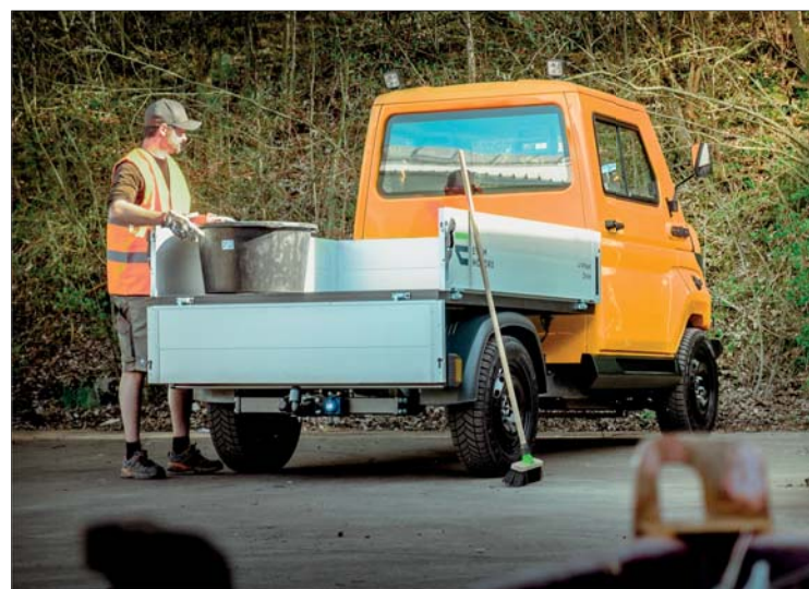
V současné době je nabízena podvozková platforma například pro agregace korby, korby s plachtou, třístranný sklápěč nebo skříňovou nástavbu pro rozvoz zásilek
