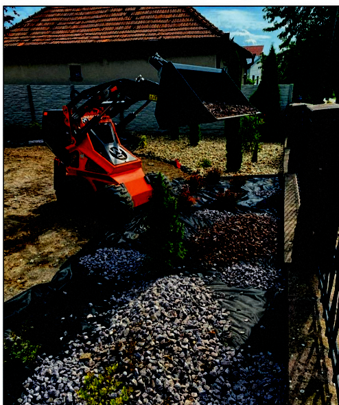
Lýžica je skvelá na presun sypkých materiálov, napríklad zeminy, piesku či kameňa. Vhodná je aj na prevážanie vriec s materiálom
