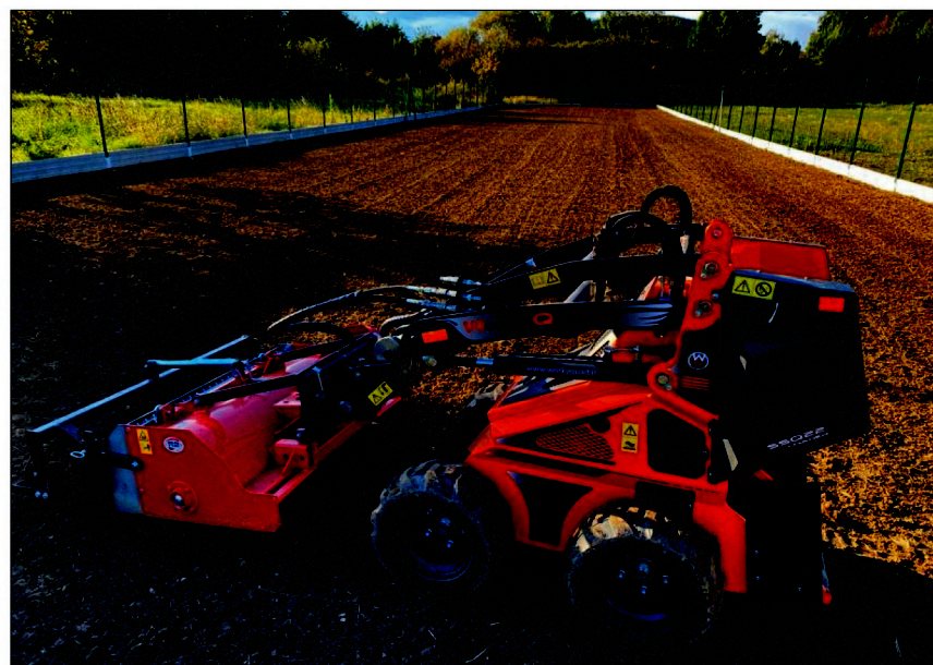
Rekultivátor R2 Rinaldi zo záberom 100 cm, čo je spätná fréza, dokáže premeniť tvrdú zemiu na prach
