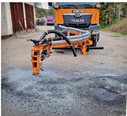
Vysprávkové soupravy STP mohou mít zadní nebo čelní aplikační rameno (foto) ovládané joystickem nebo na dálku radiem
