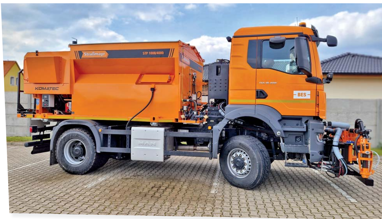
K dispozici je hned několik variant a velikostí turbo vysprávkových souprav (patcherů) pod společným označením STP
