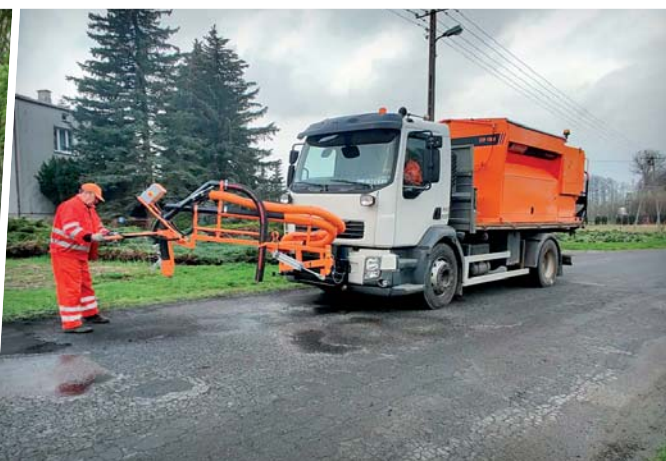
Vysprávkové soupravy STP mohou mít zadní nebo čelní aplikační rameno (foto) ovládané joystickem nebo na dálku radiem
