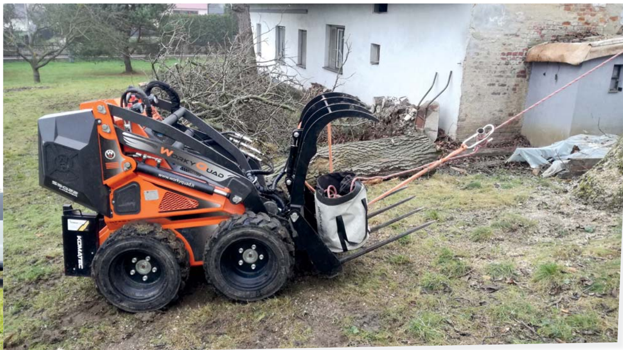
Model SSQ 22 je osazen japonským motorem Honda GX690 s výkonem 22 koní
