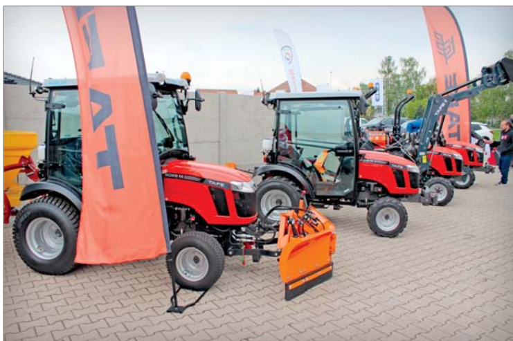
Kompaktní traktory TAFE jsou k dispozici s výkony motorů od 18 do 74 koní s mechanickými i hydrostatickými převodovkami
